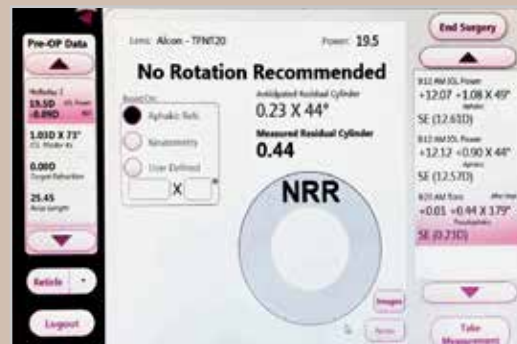
Figura 3 - Após o implante e posicionamento da LIO, o ORA não recomenda rodar mais a LIO (NRR - No Rotation Recommended), sinal do correto posicionamento da LIO no saco capsular. Note também o equivalente esférico residual (0.23D) após a leitura com o paciente pseudofático.
