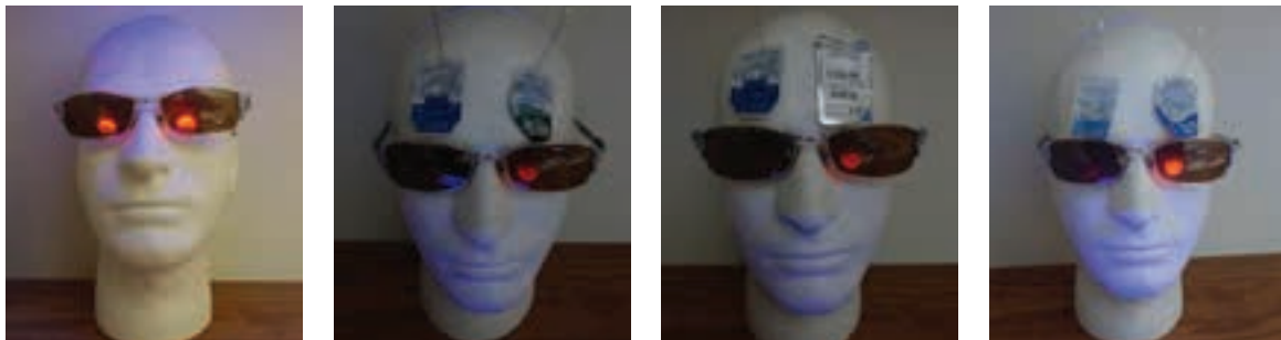
Figura 3: Na imagem à extrema esquerda, o manequim apresenta olhos com extrema fluorescência, sem lentes de contato, evidenciando grande exposição à radiação UV. Nas outras imagens, evidencia-se um brilho alaranjado mais intenso nos olhos com lentes de contato que não bloqueiam os raios UV (olhos esquerdos dos manequins, em verde) do que naqueles com um bloqueador de raios UV Classe 1 (olhos direitos dos manequins, em tons de azul).
