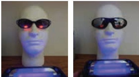
Figura 2: A fluorescência da tinta sensível à radiação UV (imagem à esquerda), vista na região dos olhos do manequim, indica exposição aos raios UV vindos de baixo, mesmo com o uso de óculos de sol. Óculos que ficam mais próximos à face (imagem à direita) fornecem mais proteção que outros modelos de óculos solares, como os da imagem à esquerda.
