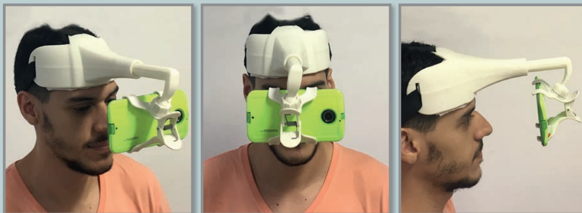
OnEyes, foi desenvolvido com impressão 3D e componentes com custos reduzidos.
