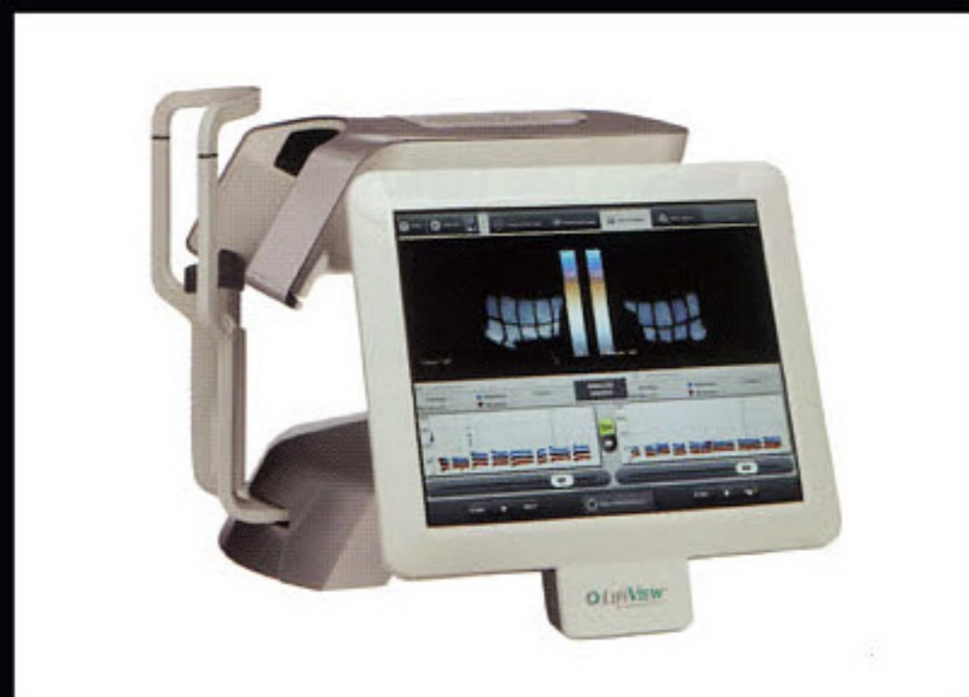
Figura 1: O interferômetro LipiView visa detectar pacientes com olho seco devido à disfunção da glândula meibomiana
